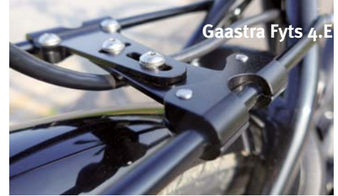
Stabilisiert das Gepäckabteil: Brace.
