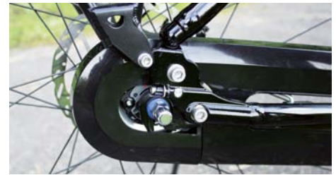
Vereinfacht die Wartung: Spezial-Ausfallende.
